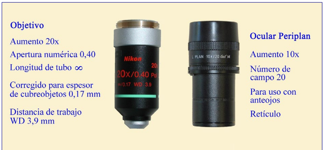
Figura 1-5. Ejemplo de objetivo (Nikon CFI Achromat 20x P) y ocular (Leica Periplan con retículo).
