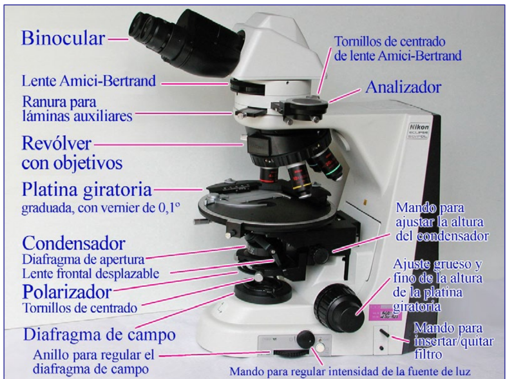
Figura 1-6. Componentes de los microscopios de polarización (Nikon Eclipse 50/Pol; Leica Laborlux 12 Pol).
