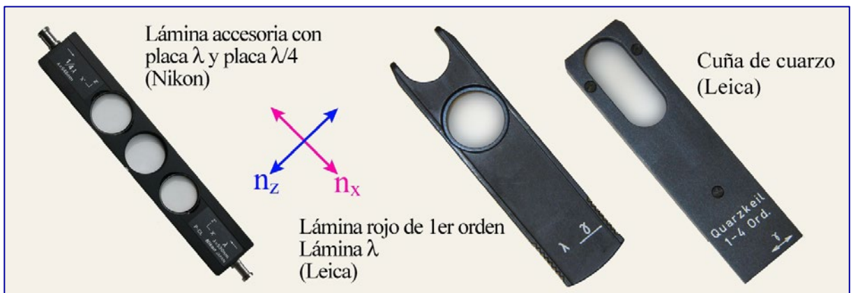
Figura 4-42. Láminas auxiliares compensadoras: rojo de primer orden (lámina l ), \lambda/4 y cuña de cuarzo.
